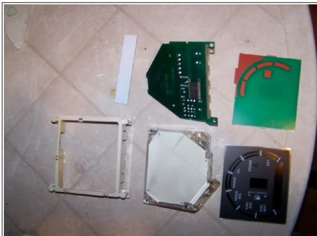
La petite lame est un des points fondamentaux du circuit, il s'agit d'une sorte de mousse conductrice (en graphite?) qui assure le contact électrique entre les contacts du circuit imprimé:
