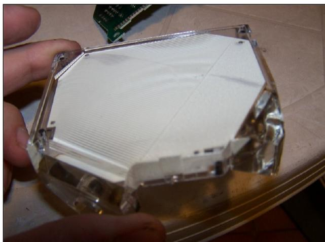
La périphérie de ce réflecteur reçoit la source lumineuse canalisée depuis les ampoules par les éléments en plexi (verre?). Le réflecteur en aluminium collé derrière le plexi renvoie la lumière vers l'avant. Les stries semblent couverte d'une couche blanche (alumine?), je suppose qu'il s'agit d'une sorte de miroir sans tain ayant pour rôle de diffuser la lumière.
