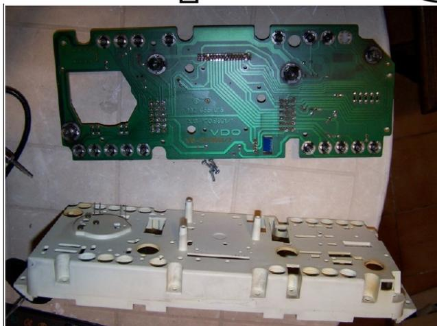
Voici le fameux halogène qui se trouve en haut à gauche du circuit quand on le regarde de dos. Une seconde "grosse" ampoule éclaire le côté gauche de l'ODB ainsi que le côté droit du tacky.
