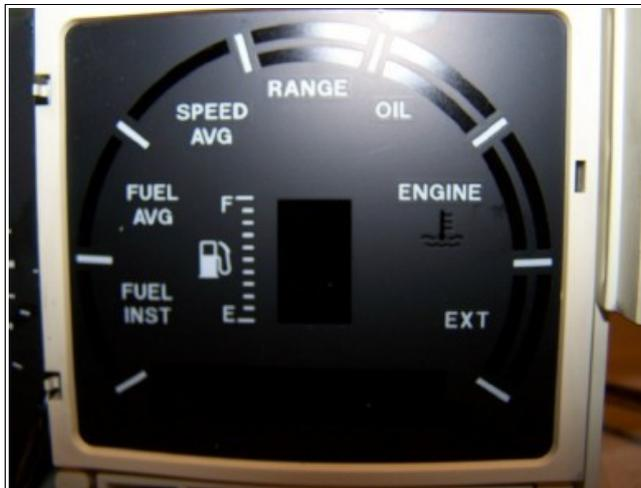
Ce bloc est fixé au grand circuit imprimé par 4 vis, dont une planquée sous un coin du cache plastique carré du tackymètre.
