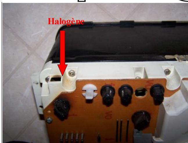
Le manque d'étanchéité avec le compartiment moteur (3ème erreur) fait le reste. Ainsi, un bon lavage Karcher ou beaucoup d'humidité, font que de l'eau arrive jusqu'à la base du LCD et font contact n'importe comment. Ce n'est pas grave, ça disparaît en séchant.
