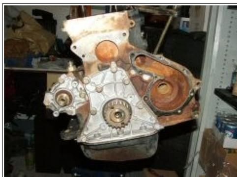
sur le coté boite, l'eau s'écoule derrière le volant moteur pas évident a voir avec la boite de monté elle est juste derrière le capteur de PMH
