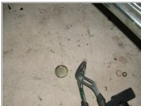
pour la pose il faut l'enduire de frein filet et la mettre dans l'axe
