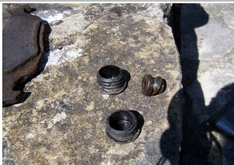
Les caches des vis de maintien de l'étrier et le cache de la vis de rattrapage
